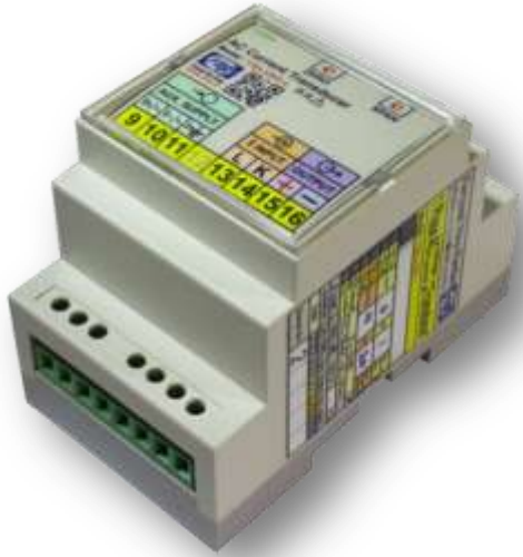
شکل ۱- شکل ظاهری ترانسدیوسر DC مدل TRM-420N
